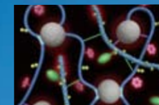
コロエネゴム 特殊な合成ゴムと改質天然ゴムを採用し、低燃費性とグリップ力の確保の両立を実現した、独自の新材料。
